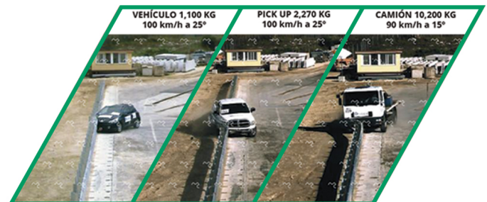
Pruebas impactadas y superadas Nivel de contención NC-4 (MASH)
